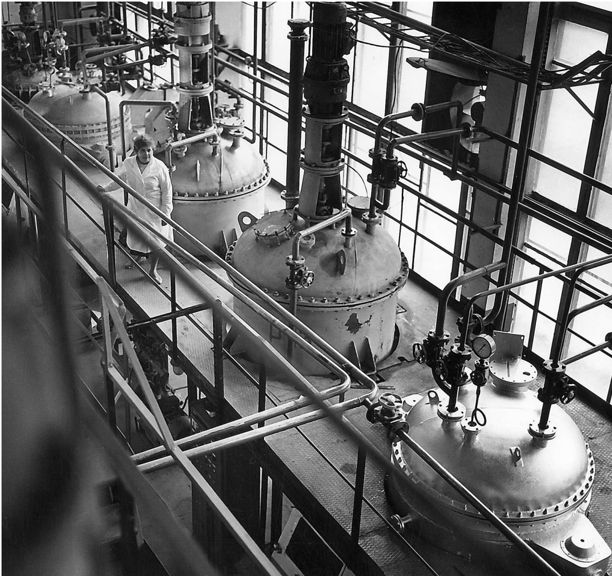
В цехе СКТБ катализаторов Министерства химической промышленности. Установка приготовления цеолитных катализаторов.
