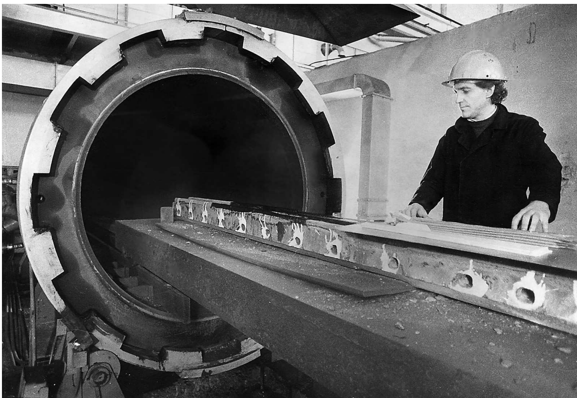
Камера для упрочнения взрывом стрелочных крестовин на Новосибирском стрелочном заводе — этот метод пришел сюда из Института гидродинамики.
